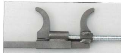
手前の爪を利用すると縮める作用だけでなく広げる作用もできます。対応機種 大、中、小
