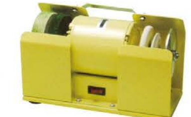
4303 ミニハイスケーア2型ダイヤ円盤セット 27,500E Electric chisel sharpening machine ●160×110×255mm ●4.6kg ●1入 ●仕様/付属品(平バフ・白バフ・丸バフ・角バフ・ダイヤ円盤 青棒) AC100V 60W 回転数3400回/分(60Hz)・2800回/分(50Hz) ●JAN:4976489801352
